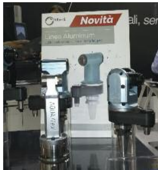
Aluminum è la linea di teste angolari Alberti dal peso e dimensioni ridotti
