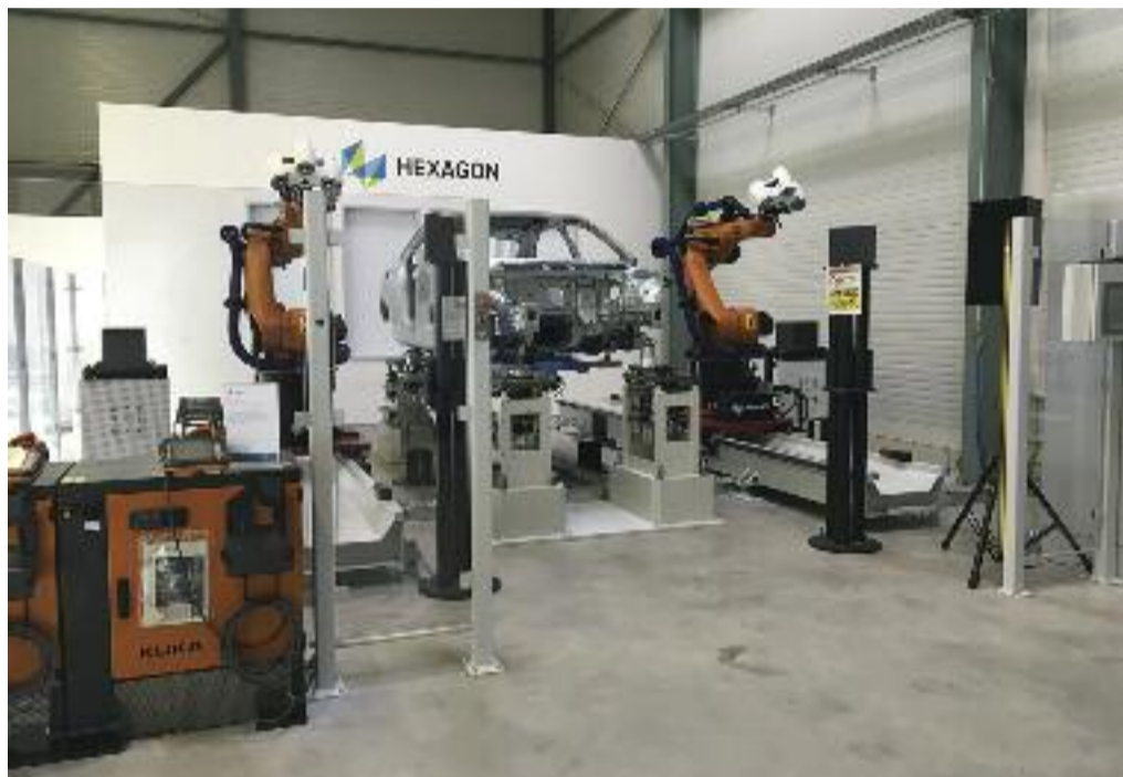
Sistema a bracci contrapposti per la misura dimensionale delle carrozzerie di auto direttamente in linea
