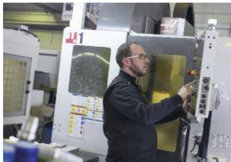
Macchina per foratura/maschiatura Haas DT-1 presso Termomacchine srl
