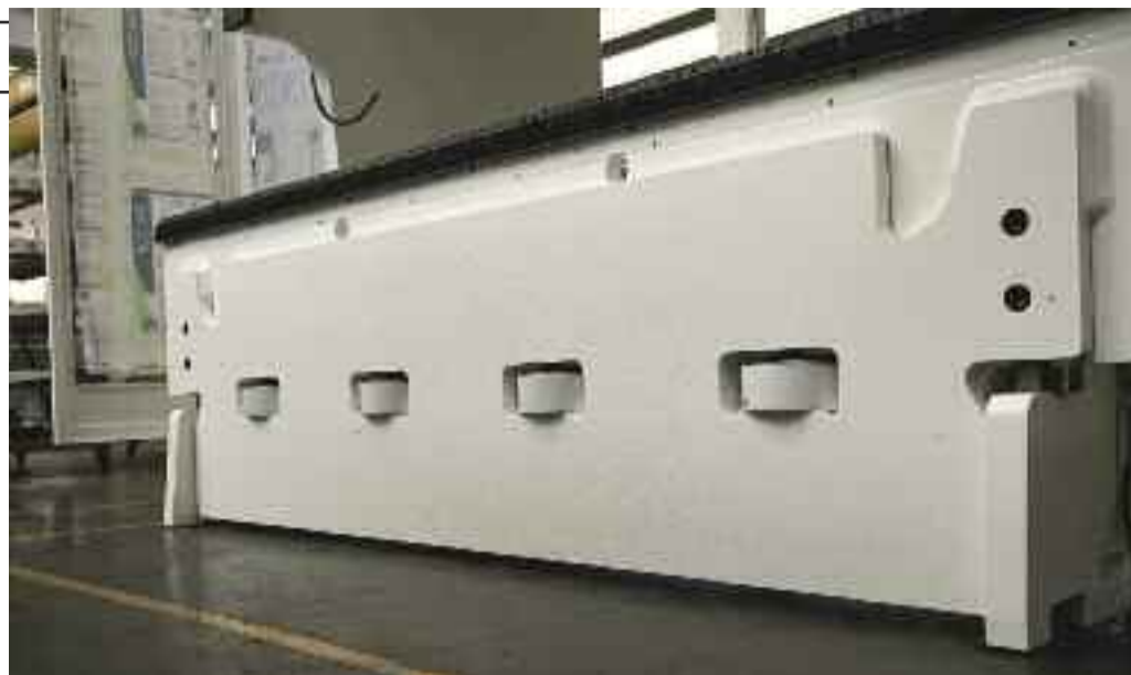
Sistema di cilindri idraulici impiegato per la bombatura del banco di piega
