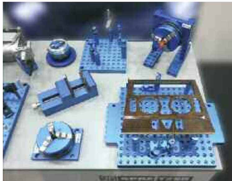
La maggior parte degli elementi del sistema ALUMESS sono realizzati in alluminio ad alta resistenza e successivamente anodizzato per garantire maggiore protezione da corrosione
