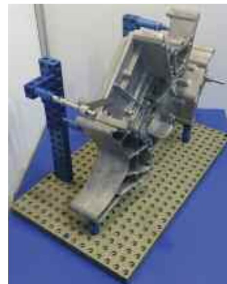
La trama precisa di foratura sul pallet permette la costruzione facile, precisa e riproducibile del proprio dispositivo di bloccaggio
