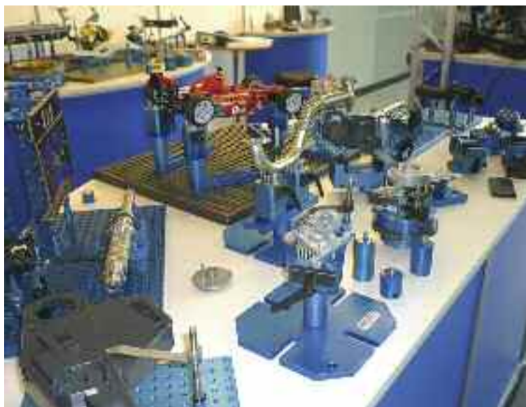
Il sistema modulare offre un grande numero di accessori che permettono di comporsi facilmente tra loro per la risoluzione di ogni problema di serraggio pezzo
