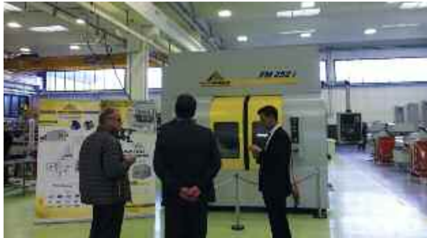
Il centro di lavoro bi-mandrino ad asse orizzontale FM 252 i con interasse da 500 mm
