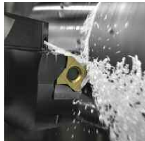
CoroTurn® 300 con tecnologia iLock™ e inserti a otto taglienti
