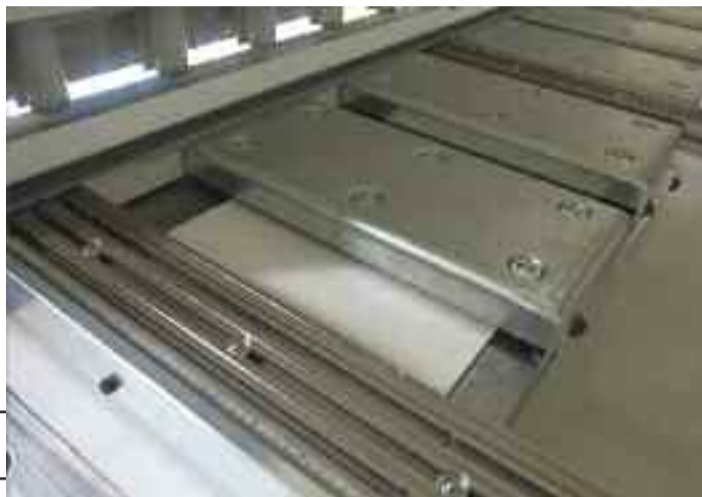
Sistema di sfere di scorrimento con dispositivo pneumatico
