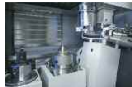
Die VLC 100 GT kann als vertikales Schleifzentrum oder als Dreh- und Schleifzentrum zum Einsatz kommen
