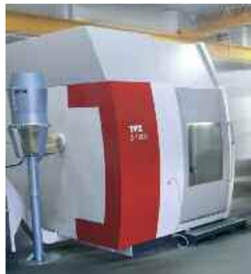
Il nuovo rivestimento macchina più alto della serie TFZ consente percorsi Y più lunghi e lavorazioni di pezzi più grandi.
