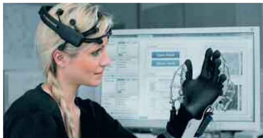
Trasmissione di impulsi dall'uomo al robot, trasformati in movimento (fonte Festo).
