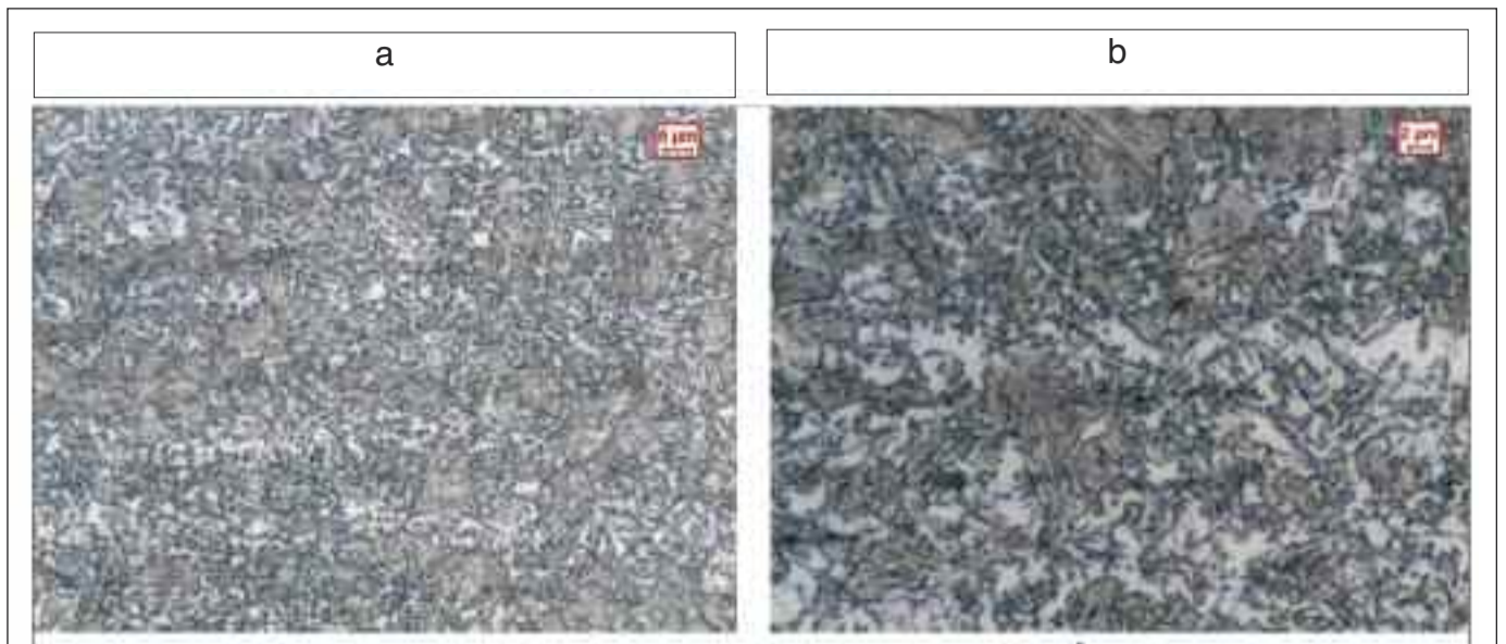
Fig. 6: Zona termicamente alterata dei campioni analizzati (attacco Nital 2%).
