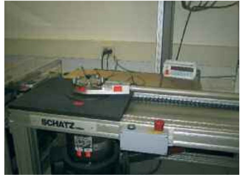
Il banco per la misurazione dei momenti torcenti installato all'interno del centro Prore S.r.l. accreditato Accredia (L'Ente Italiano di Accreditamento), diretto da Marco Corradini.
