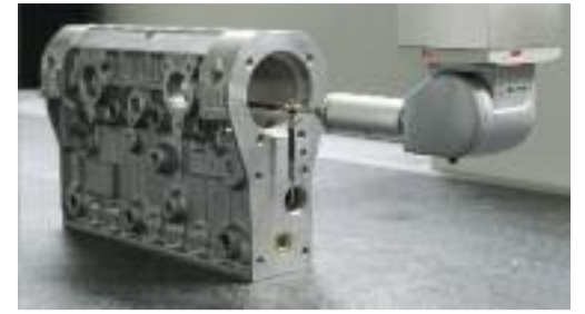
La gamma HP-S-X1 comprende, tra le altre, la versione HP-S-X1H che offre l'opzione per l'uso della testa di misura indexabile per una migliore accessibilità al pezzo
