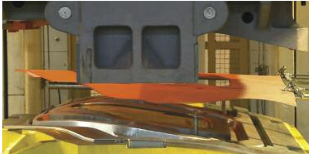
Deformazione a caldo di porzioni di telaio saldati laser. Fonte: ArcelorMittal Tailored Blanks
