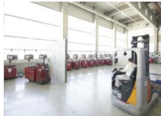
Presso vari punti dello stabilimento sono dislocate sale di ricarica presso le quali i carrellisti possono sostituire le batterie da trazione scariche con batterie cariche in pochissimi minuti
