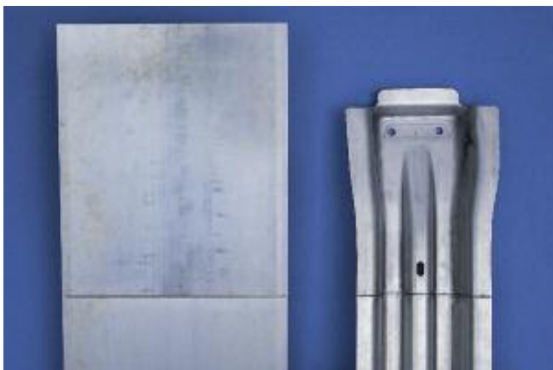
Pannelli saldati laser prima e dopo la deformazione
