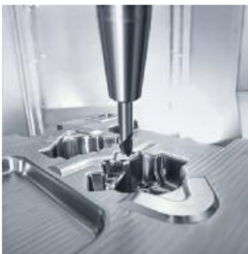
Il grande fascino della lavorazione a 5 assi deriva principalmente dalla possibilità della lavorazione simultanea di geometrie complesse
