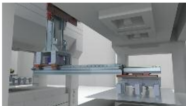
Attuatore telescopico per l'asservimento nella lavorazione della lamiera firmato Rollon
