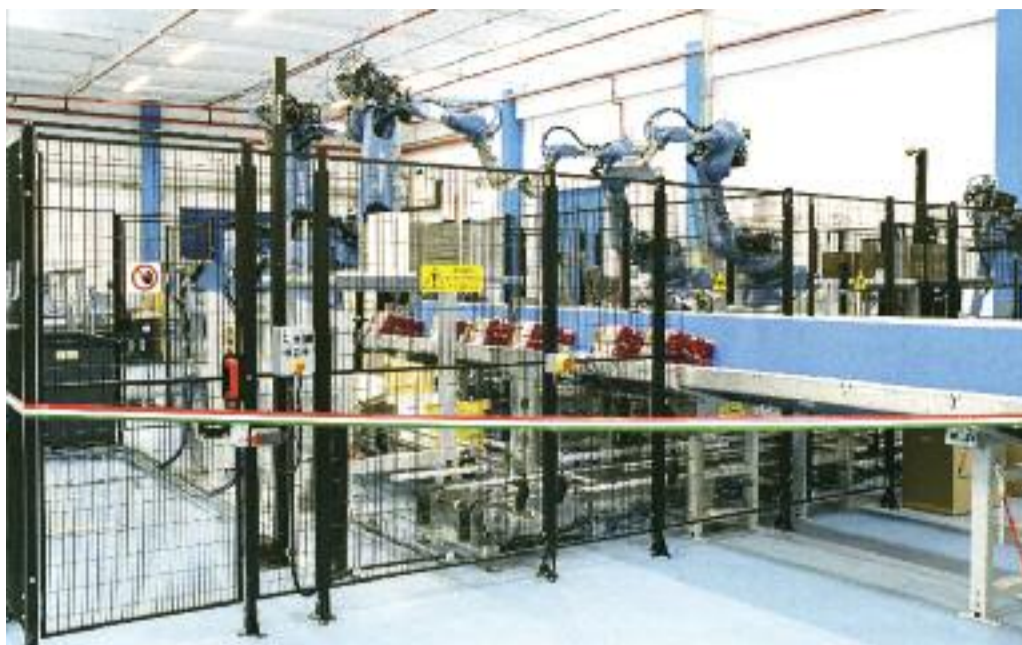
La linea di co-packing automatizzata da Siscodata con 5 robot Comau. L'automazione consente la realizzazione di 40 espositori all'ora
