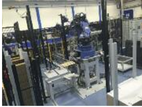
Comau NJ40, il robot impiegato nella preparazione delle confezioni di cartone che ospiteranno i prodotti
