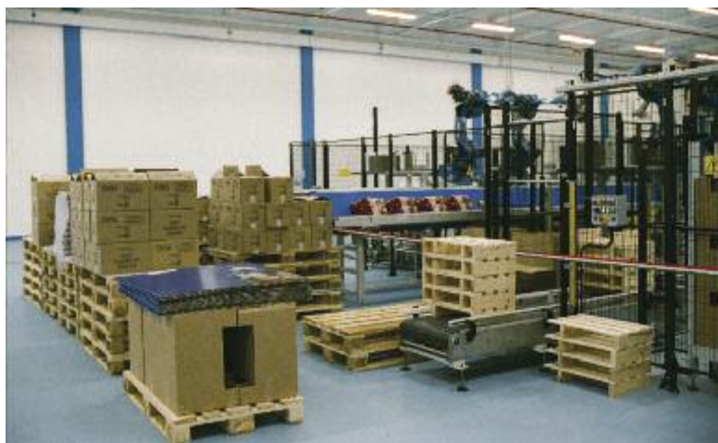
L'area di caricamento, a cura degli operatori, dei prodotti che, inseriti nella linea, saranno "riconfezionati" dai robot Comau
