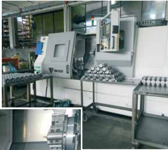
Produzione di raccordi a 3 vie su tornio CMZ.
