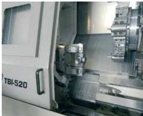
Lavorazione di raccordo a 2 vie su tornio CMZ con attrezzatura di serraggio NEVE.
