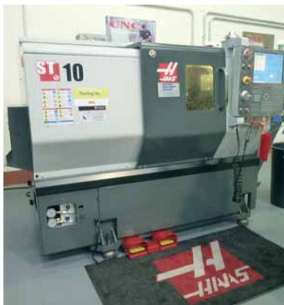
Le due macchine utensili Haas installate presso il laboratorio: un centro di lavoro verticale con tavola rotobasculante e un centro di tornitura.
