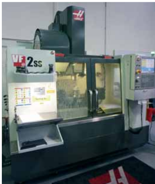
Le due macchine utensili Haas installate presso il laboratorio: un centro di lavoro verticale con tavola rotobasculante e un centro di tornitura.
