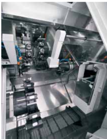
Zona di lavoro del tornio polifunzionale TX di CMZ.
