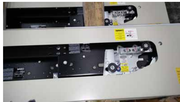
Primo piano del meccanismo di apertura e chiusura porte per ascensori prodotte da Sematic
