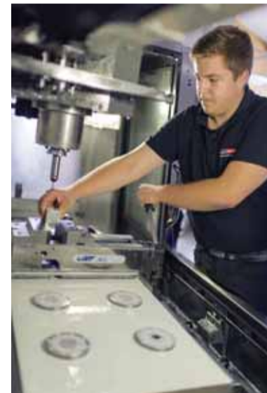
I centri di lavoro Haas presso Metallmanufaktur sono configurati in modo identico, usando sistemi di presa pezzi a punto zero e lo stesso tipo di utensili da taglio. I tempi di cambio del pezzo sono di appena 5-10 minuti, con pezzi totalmente intercambiabili tra macchine. La foto mostra il cofondatore Roman Zejnic
