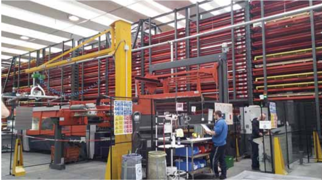
Il reparto produttivo all'interno di Sematic: è ben visibile il magazzino lamiera che asserve le tre macchine laser
