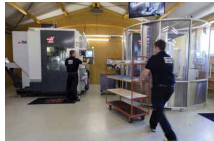
Uno dei due centri di lavoro universali a cinque assi UMC-750 è equipaggiato con un sistema di carico automatico per lavorazioni durante l'intera giornata
