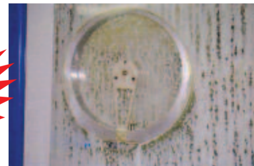
Oblò rotante CLEARVISION spento, la visibilità della lavorazione è compromessa dal liquido refrigerante
