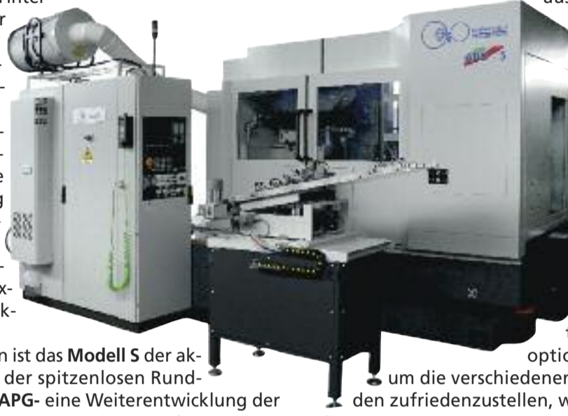
Das Modell S der aktualisierten Ausführung der spitzenlosen Rundschleifmaschinen - Serie APG- eine Weiterentwicklung der vorherigen Version
