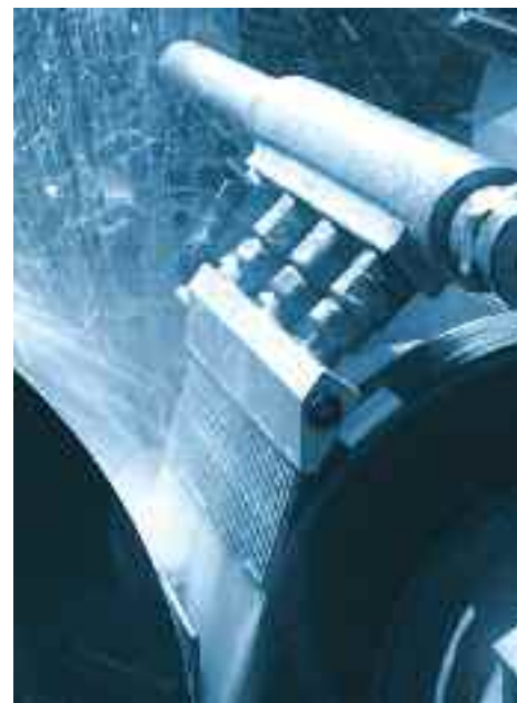
Sulla nuova APG possono essere montate mole fino a 500 mm di diametro per 250 mm in larghezza operanti a 120 m/s.
