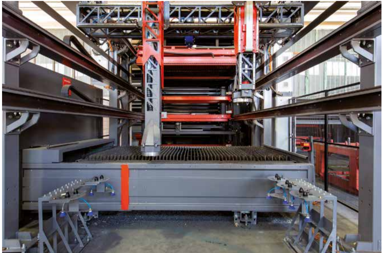
Scorcio del magazzino lamiera che asserve tre macchina laser Bystronic
