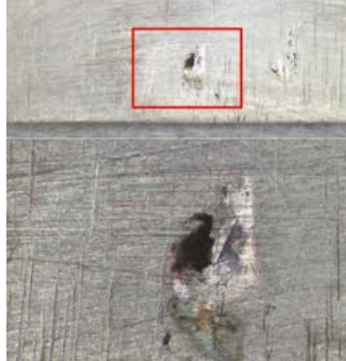
Fig. 24 - Lato diluizione del riporto, dettaglio di un pit di corrosione - C1
