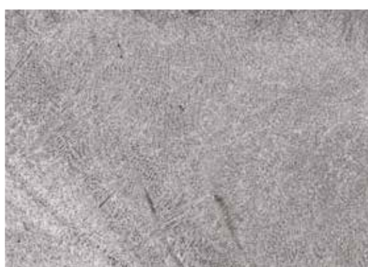
Fig. 29 - Microstruttura dendritica della zona fusa - A1
