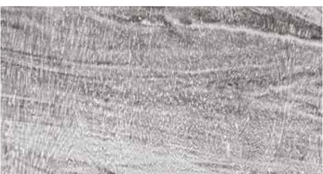
Fig. 48 - Microstruttura della zona fusa - C2
