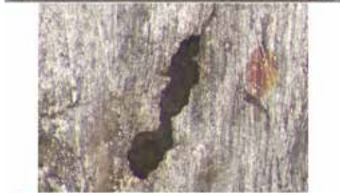
Fig. 23 - Lato dritto del riporto, dettaglio di un pit di corrosione - C1
