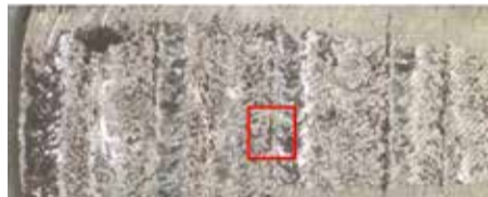
Fig. 23 - Lato dritto del riporto, dettaglio di un pit di corrosione - C1
