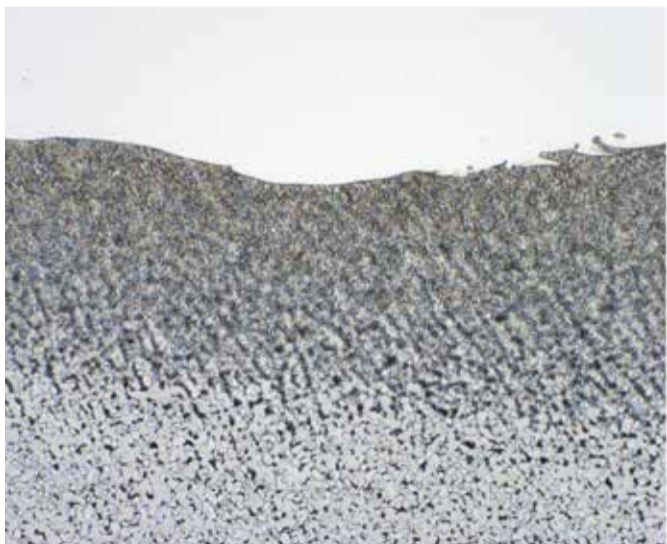
Fig. 47 - Dettaglio della ZTA - C2.
