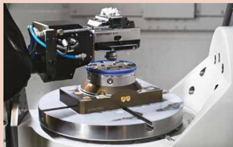
Morsa autocentrante R-C2 con il pezzo bloccato viene caricata come un pallet nel modulo a punto zero sulla tavola macchina.
